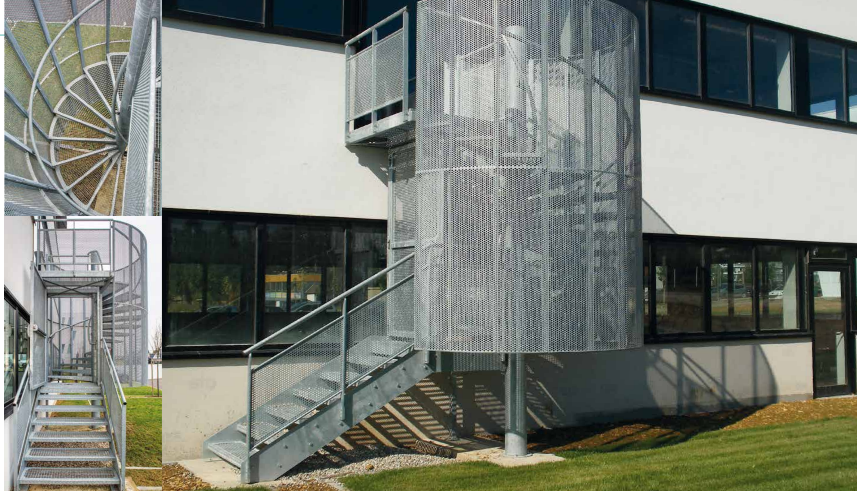
Escalier Mixte Hélico/Droit de Secours 1UP. Marches en caillebotis electroforé 30x19. Garde-corps (CT15) en tôle perforée R15T20 toute hauteur. Ensemble galvanisé. Maison des Médecins. METZ BORN Y 57
