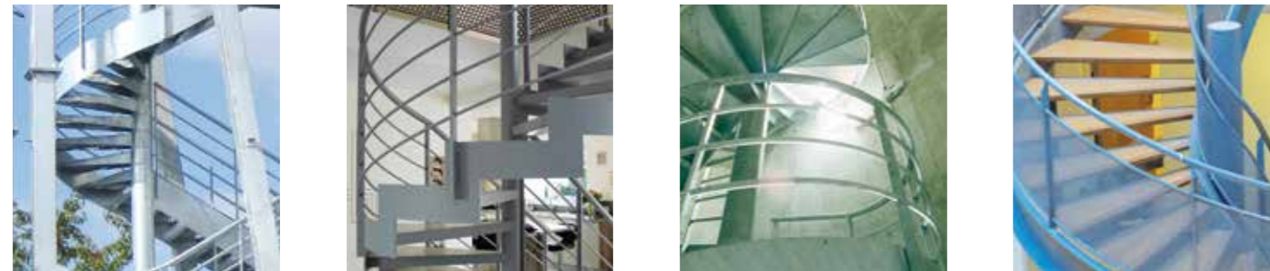
Escalier Mixte Hélico/Droit de Secours 1UP. Marches en caillebotis electroforé 30x19. Garde-corps (CT15) en tôle perforée R15T20 toute hauteur. Ensemble galvanisé. Maison des Médecins. METZ BORN Y 57
